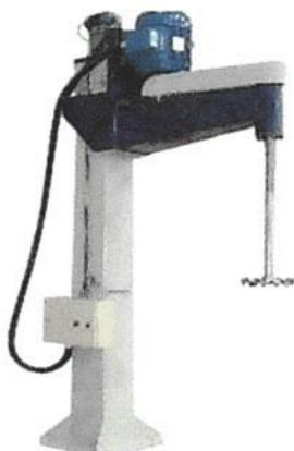
Figura 3: Dispersor para dissolver misturas do tipo sólido-líquidos e líquido-líquidos.
